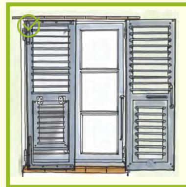
Les persiennes en bois dites à la génoise constituent l'essentiel des volets de la vieille ville et de la ville réglée. Les volets à écharpe dits en « Z » et les volets roulants extérieurs ne sont pas autorisés afin de ne pas banaliser l'architecture bastiaise.
