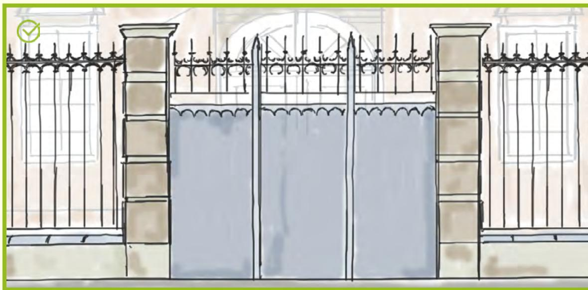
Le dispositif de **grille en fer forgé sur mur bahut** permet une continuité de traitement entre les palais en alignement de rue et les palais avec jardin sur rue. **Le portail en barreaudage avec ou sans tôle pleine rivetée est placé au centre.**
