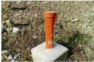
Piezomètre de 40 mètres de profondeur avec dalle béton de 50cm sur 50 cm.
