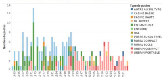
Pyramide des âges des postes HTA/BT, par typologie, en 2023
